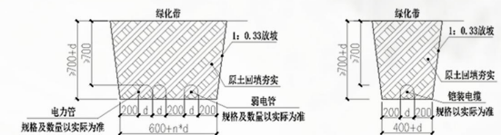
电缆穿管绿化带下敷设大样图
