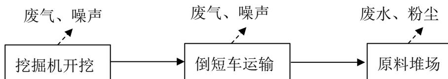
图 3.2-1 挖掘机采砂作业及产污环节图
