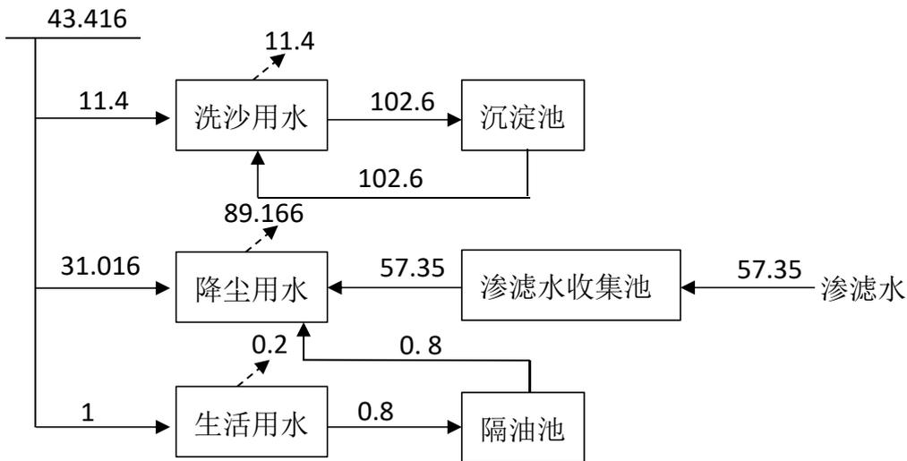
图 3.2-3 项目水量平衡图 单位: m<sup>3</sup>/d (晴天)
