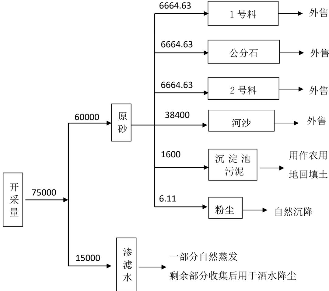
图 3.2-2 本项目物料平衡图 单位 t/a
