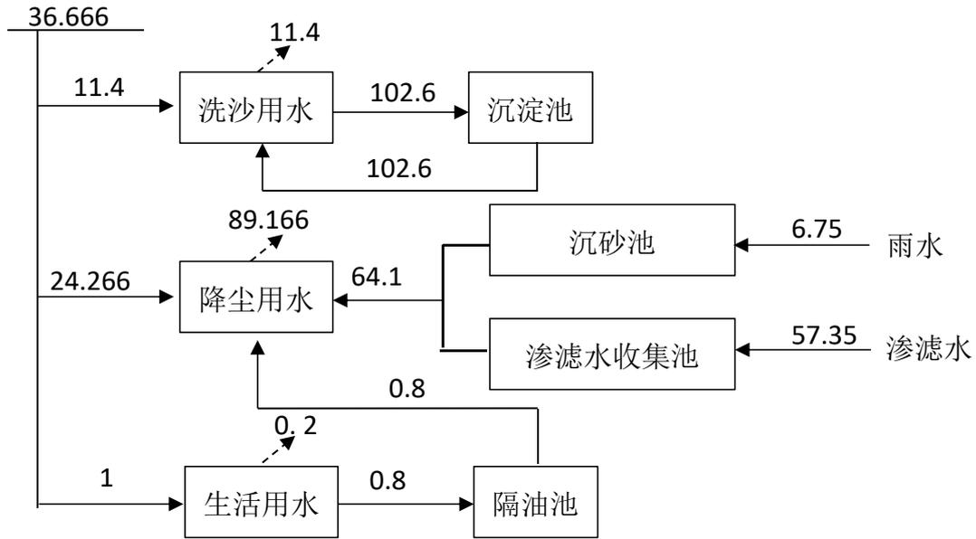
图 3.2-4 项目水量平衡图 单位: m³/d (雨天)
