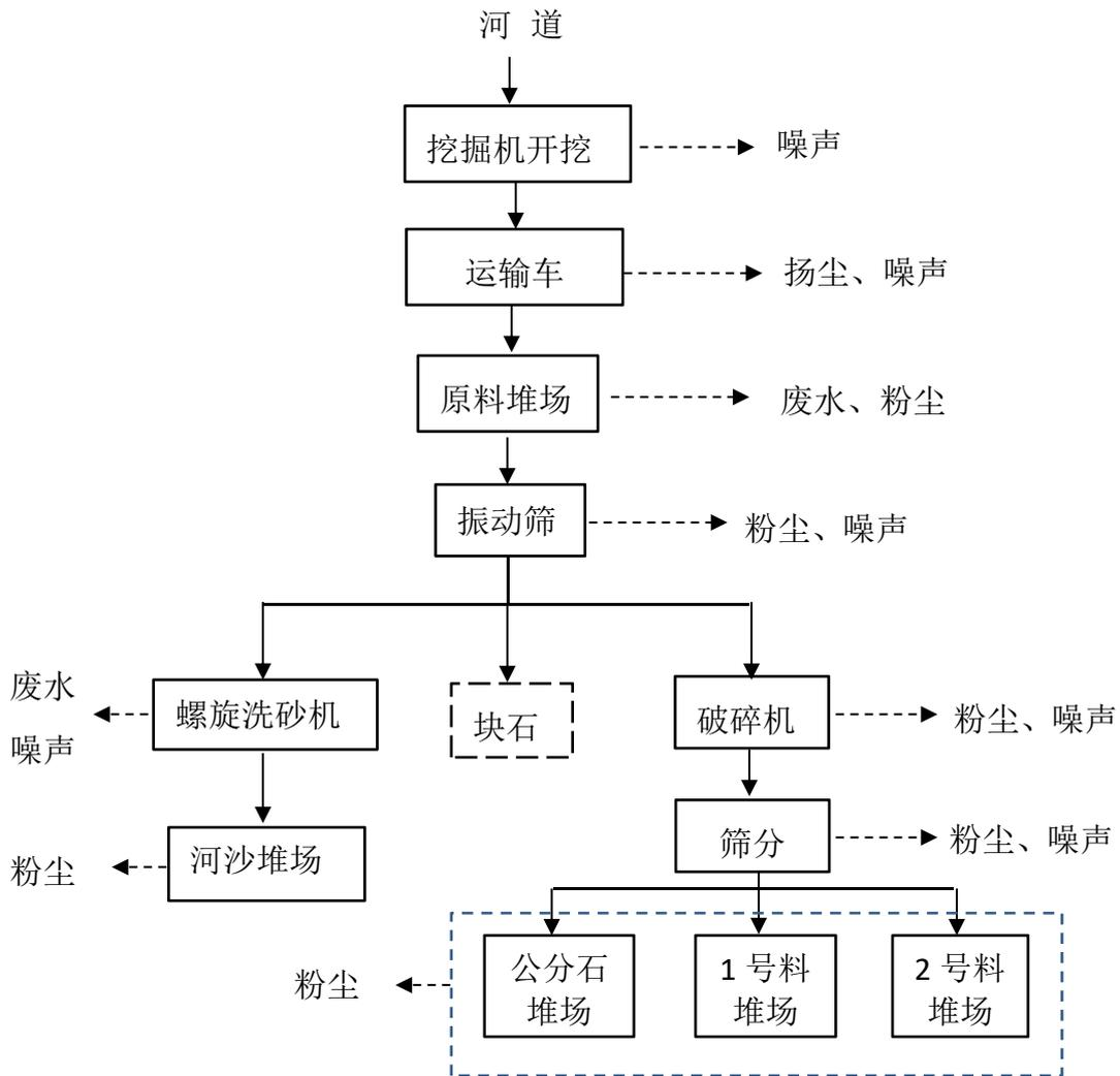
图 3.2-1 生产工艺流程及产污环节
