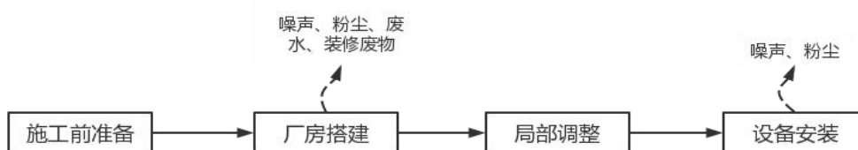
图 2-3 施工期工艺流程及产污节点图
