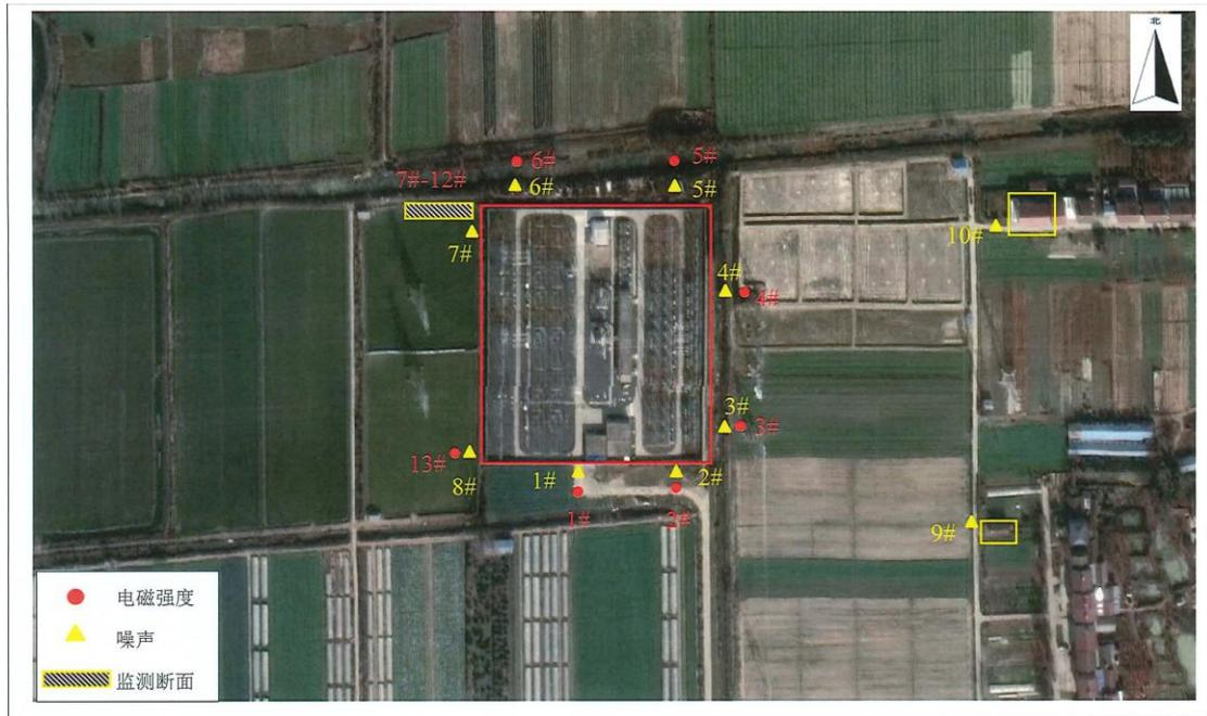
图 3-1 类比许台 220kV 变电站监测点布置图
