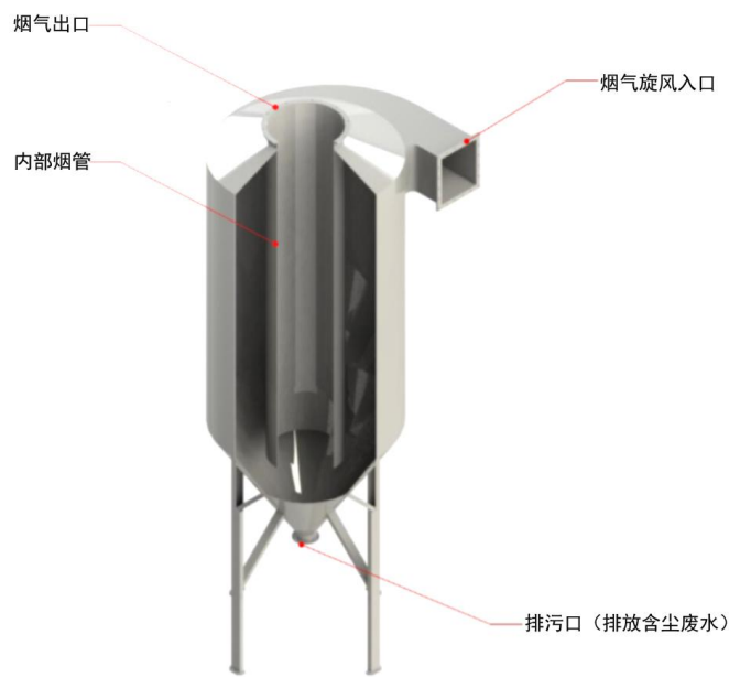
图 6.2-3 旋风除尘器结构原理图
