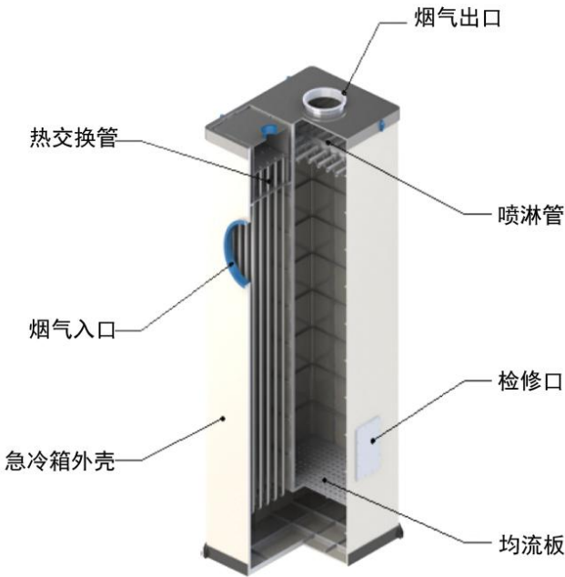
图 6.2-2 急冷箱原理结构图
