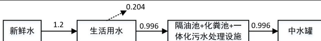
图 2-6-2 本项目水平衡图 单位：m³/d
