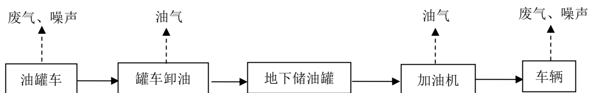
图 5-4 柴油加油工艺流程及产污节点图
