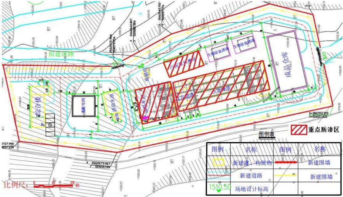
图 5.2.3-8 污泥综合处置工程分区防渗图
