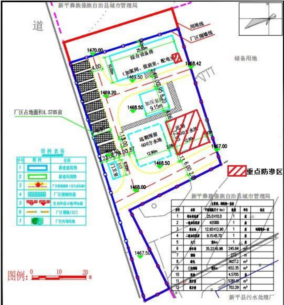
图 5.2.3-7 再生水处理工程分区防渗图
